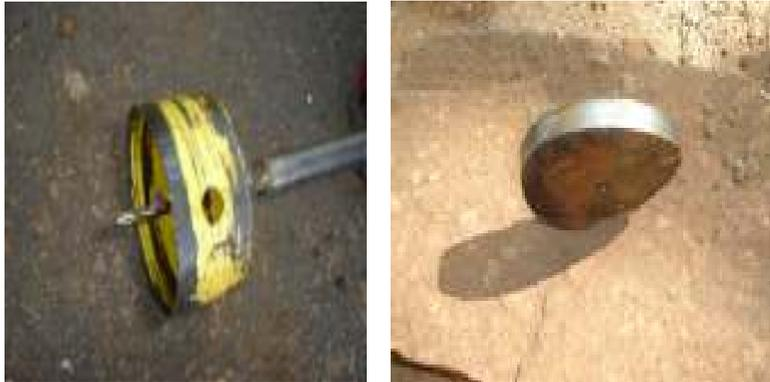
*Fresa (serra copo) e pedaço do tubo resultante do corte da tubulação*
