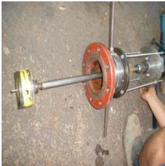
*Equipamento montado com a haste e fresa (serra copo)*
